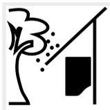
Wechselrichter vor herabfallenden Teilen schützen, die in die Lüftungsöffnungen des Wechselrichters gelangen können.
