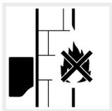
Wechselrichter auf nicht entflammbarer Montagefläche montieren.
