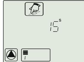
Die Zeit, in der die Pumpe beim Einschalten mit der eingestellten maximalen Leistung läuft.
