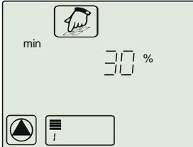
Minimale Pumpenleistung bei Drehzahlregelung.
