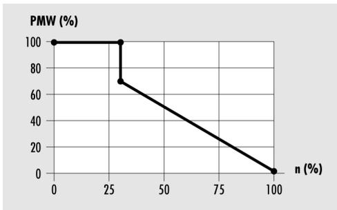
PWM (%) – invertiertes PWM-Signal
