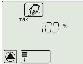
Maximale Pumpenleistung bei Drehzahlregelung.
