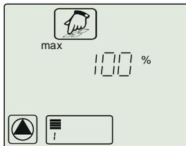
Maximale Pumpenleistung bei Drehzahlregelung.
