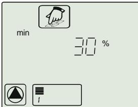
Minimale Pumpenleistung bei Drehzahlregelung.
